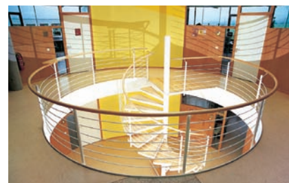
Wendeltreppe mit Ahorn-Handläufen, teilweise mit Relinggeländer mit individuellem Lochdesign, geschlossenen Stahlrohren mit eingelassenen Holzstufen
